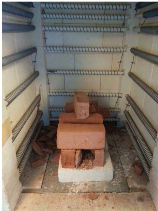
FIGURE 48 - BRICKS IN MIT KILN AFTER FIRING
